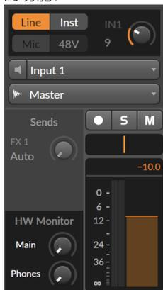
当选择输入通道1或2时，您可以可以切换输入类型，幻象电源（仅在通道1上），并调整增益。当选择输入通道3或4时，您可以切换DC滤波器和+ 12db的增益设置。所有这些控件都位于输入通道选择器的上方。
