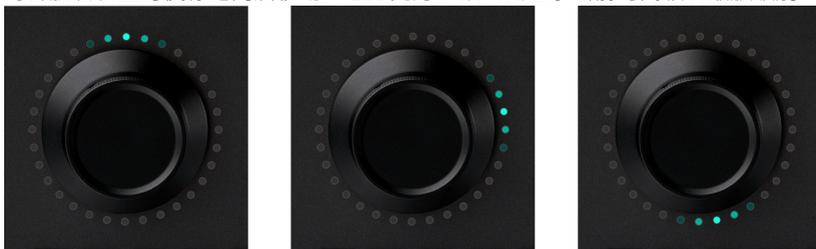
当 **Scroll** 模式已经激活，再次按下 **SCROLL** 按钮可以切换到缩放模式。两个或更多的紫色环形 LED 会亮起。顺时针旋转转盘可水平放大，逆时针旋转可水平缩小。LED 亮灯数量将根据当前的缩放级别而变化：缩小得越多，就会有越多的 LED 亮起来。
