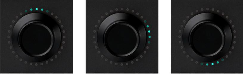
Wenn der Scroll-Modus bereits aktiviert ist, drücken Sie die SCROLL-Taste erneut, um in den Zoom-Modus zu wechseln. Zwei oder mehr LEDs des Rings leuchten in Violett auf. Drehen Sie das Center Dial im Uhrzeigersinn, um horizontal hineinzuzoomen, drehen Sie es entgegen dem Uhrzeigersinn, um horizontal herauszuzoomen. Die Anzahl der leuchtenden LEDs ändert sich entsprechend der aktuellen Zoom-Stufe: je weiter Sie herauszoomen, desto mehr LEDs leuchten auf.
