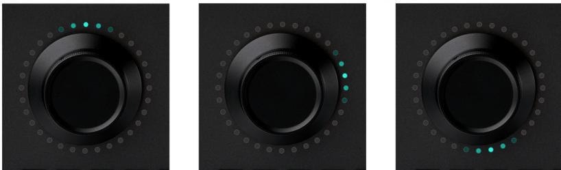
スクロールモードがすでに有効になっている場合、もう一度SCROLLボタンを押すとズームモードに切り替わります。この際、2つ以上のリングLEDが紫色で点灯します。センターダイヤルを時計回りに回すと水平方向にズームインし、反時計回りに回すと水平方向にズームアウトします。現在のズームレベルに応じてLEDの点灯数が変化します：ズームアウトするほど、LEDの点灯数が増加します。
