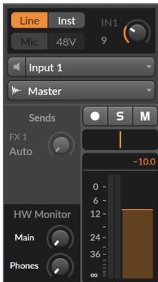
入力チャンネル1または2が選択されている場合、入力タイプを切り替えたり、ファンタムパワーを切り替えたり（チャンネル1のみ）、ゲインを調整したりすることができます。入力チャンネル3または4が選択されている場合、DCフィル
