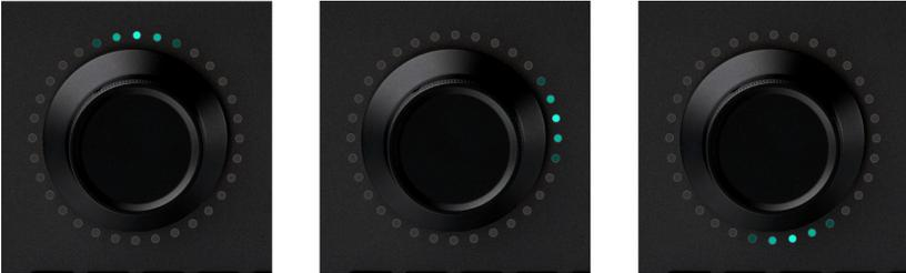
스크롤 모드가 이미 활성화된 경우, SCROLL 버튼을 다시 누르면 확대/축소 모드로 전환됩니다. 그러면 두 개 이상의 링 LED가 보라색으로 점등됩니다. 센터 다이얼을 시계 방향으로 돌리면 수평으로 확대하고 시계 반대 방향으로 돌리면 수직으로 축소합니다. 현재 줌 레벨에 따라 점등되는 LED의 개수가 달라지며, 더 많이 줌아웃할수록 더 많은 LED가 점등됩니다.
